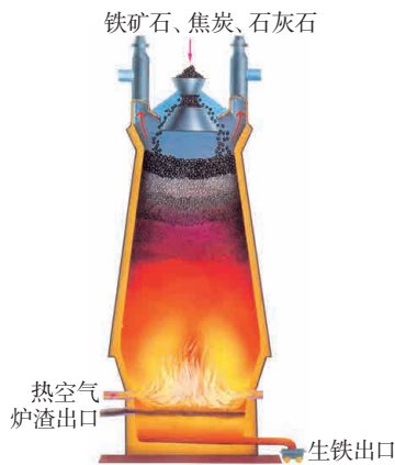
图5-11 炼铁高炉的结构
