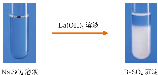
图3-4-2 \text{Ba}^{2+} 与 \text{SO}_4^{2-} 反应生成 \text{BaSO}_4 白色沉淀
