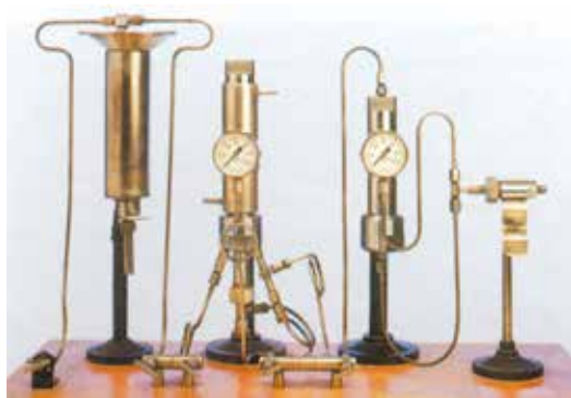
图2-2-1 哈伯合成氨实验装置
