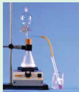
图3-5-1 模拟索尔维法的实验装置
