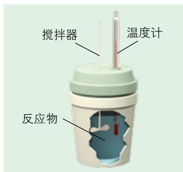
图 1-1-2 简易量热计示意图
