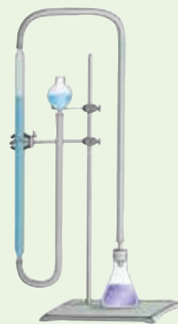
图2-3-4 量气法测定化学反应速率
