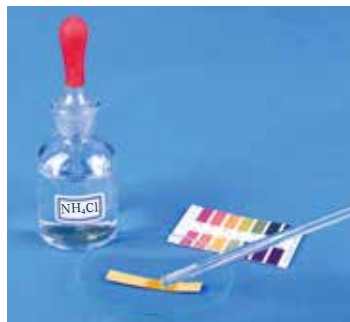
图3-2-4 溶液pH的测定
