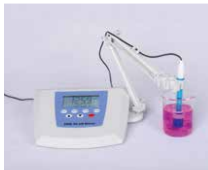
图3-1-4 用于精确测量溶液pH的酸度计
