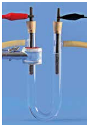
图 1-3-3 实验室电解饱和食盐水装置图
