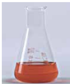
图3-2-5 CH 3 COOH溶液使石蕊溶液变红
