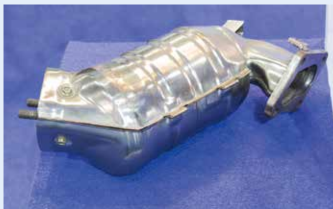
图2-1-3 一种汽车尾气净化器
