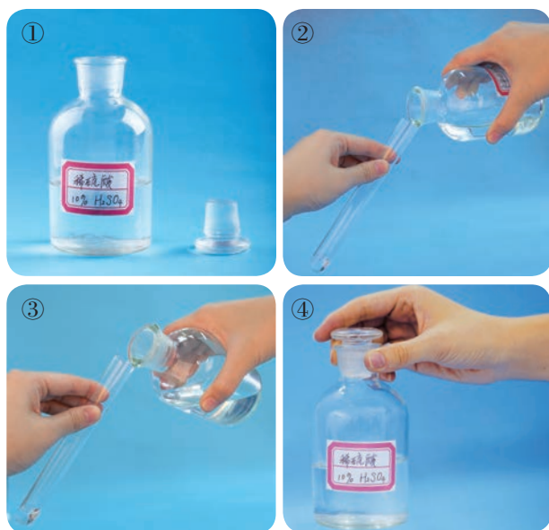
图 1-16 用倾倒法取用液体药品
