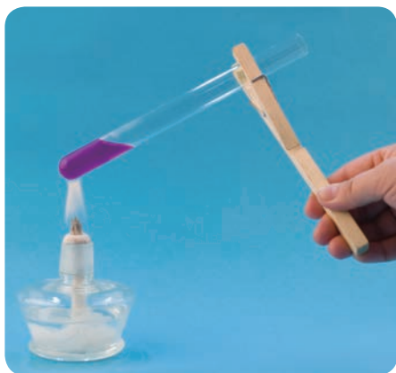
图 1-22 给试管里的液体加热
