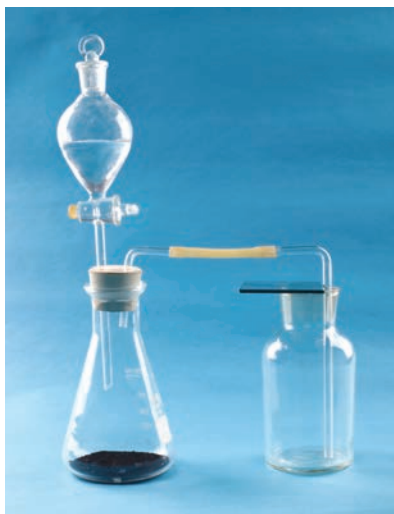
图 2-21 用过氧化氢溶液制取氧气的装置
