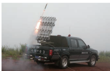
图 1-11 向空中发射催雨剂实施人工降雨
