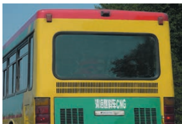
图 6-23 以压缩天然气 (CNG) 为燃料的清洁燃料汽车
