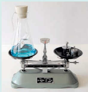
图 7-1 测定化学反应前后各物质质量总和的变化
