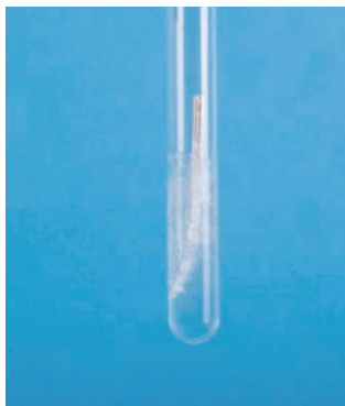
图 1-4 镁条在稀盐酸中的反应
