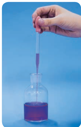
图 1-17 用滴管取用少量液体试剂
