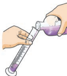
(1) 右手握试剂瓶 缓缓倾倒液体
