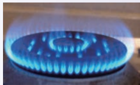
图 6-4 燃气灶的完全燃烧
