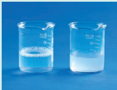
图 4-3 向硬水和软水中加入肥皂水
