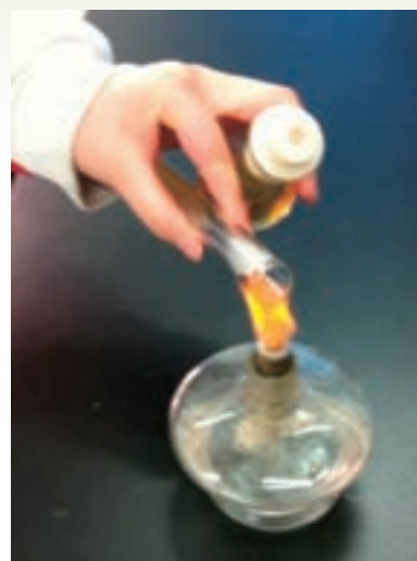
图1-6 对试管口灼烧灭菌
