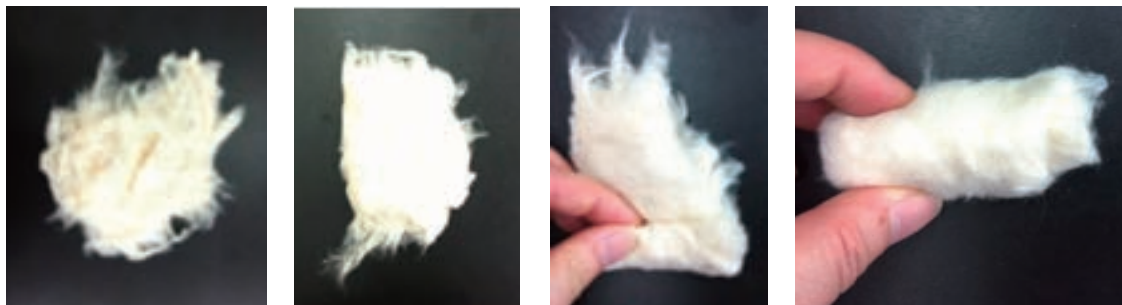
A. 将棉花铺成圆片 B. 对折后的棉花片 C. 折卷棉花片 D. 做好的棉塞
