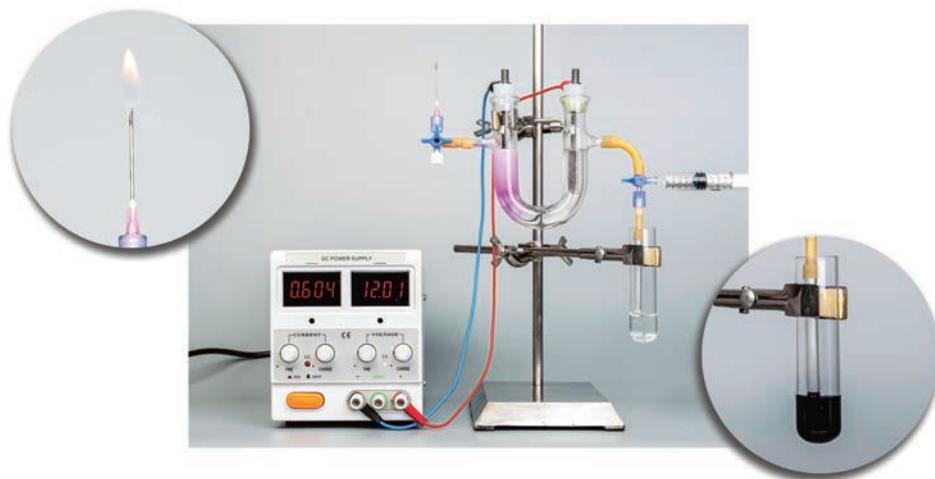
图 2.3 电解饱和食盐水装置及电解后实验现象
