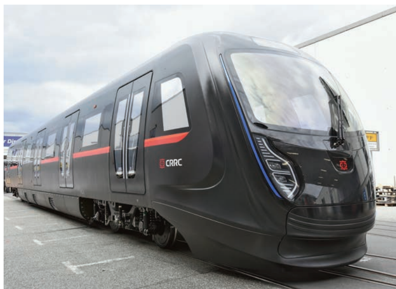
图2 我国研制出新型碳纤维复合材料地铁车
