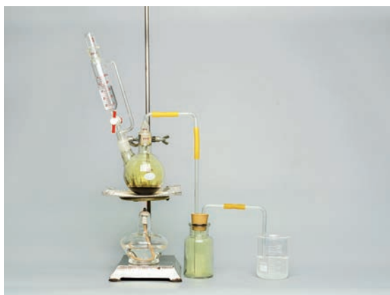
图 1.15 实验室中制备氯气的装置
