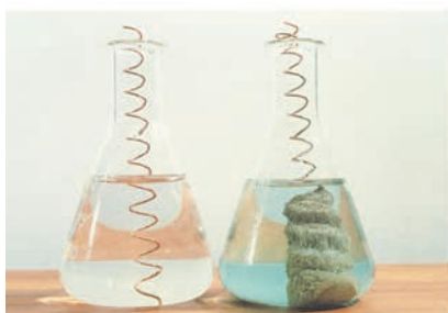
铜与硝酸银溶液的置换反应
