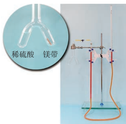
图 1.31 化学反应气体体积测定装置
