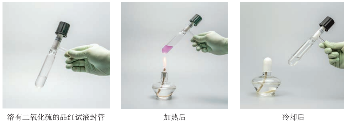
图 3.3 溶有二氧化硫的品红试液加热后再冷却
