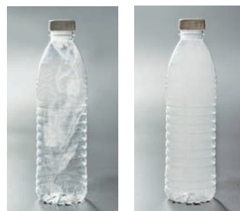
图 3.12 氨与氯化氢反应的实验现象
