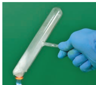
图 3.13 氯化铵受热分解
