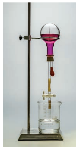
图 3.11 氨的“喷泉”实验
