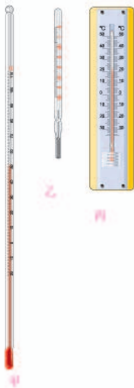
图3.1-2 实验室用的温度计、体温计和寒暑表。
