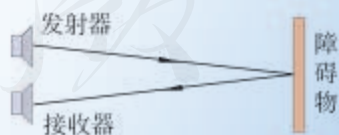
图1.4-3 超声波测距原理
