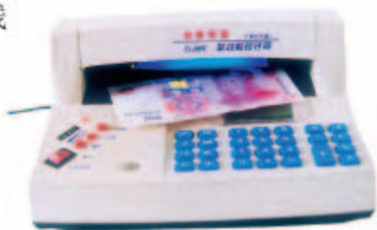
图4.5-7 紫外线使钞票上的荧光物质发光
