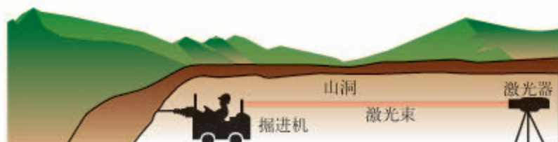
图4.1-4 激光引导掘进方向
