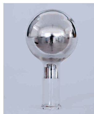
图2-3-6 葡萄糖与银氨溶液反应产生的“银镜”
