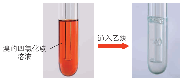
图1-3-6 乙炔与溴的四氯化碳溶液的反应
