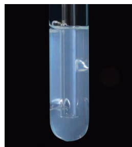
图2-2-9 向苯酚钠的水溶液中通入二氧化碳
