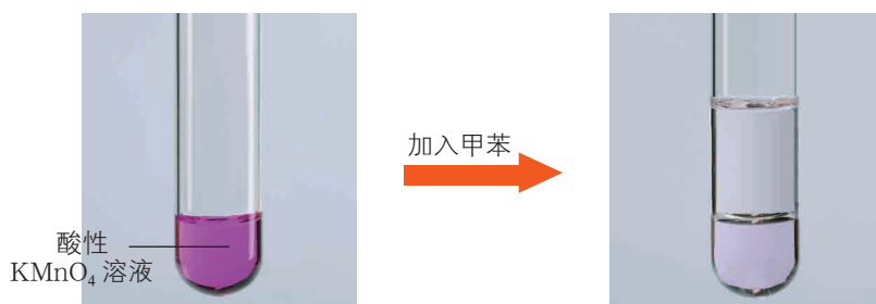
图1-3-8 甲苯与酸性 \text{KMnO}_4 溶液的反应
