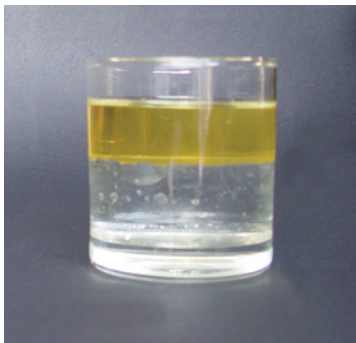
静置后的油水混合物
