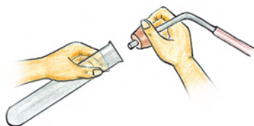
用橡皮塞塞住试管
