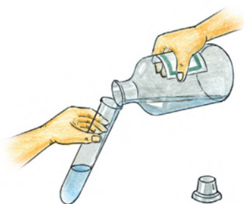
向试管中倾倒液体
