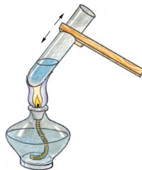
给试管里的液体加热
