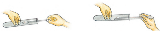
向试管中加入粉末状固体
