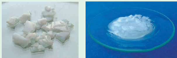
图7-14 氢氧化钠固体在空气中的变化
