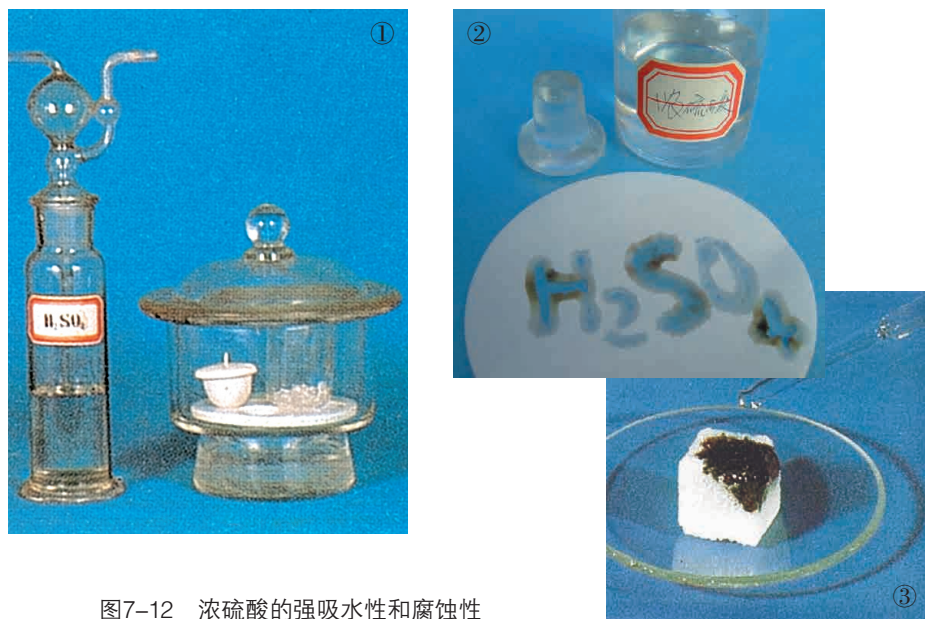
图7-12 浓硫酸的强吸水性和腐蚀性
