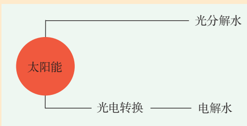
图9-10 分解水制氢气的方法
