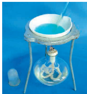
图6-18 蒸发溶剂使溶质结晶析出
