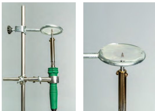
图 3.3 晶体的各向异性实验装置图
