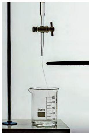
图 2.17 分子极性实验装置
