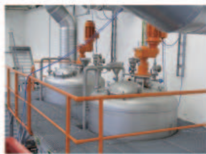
图3-32 工业化合成使用的反应釜
