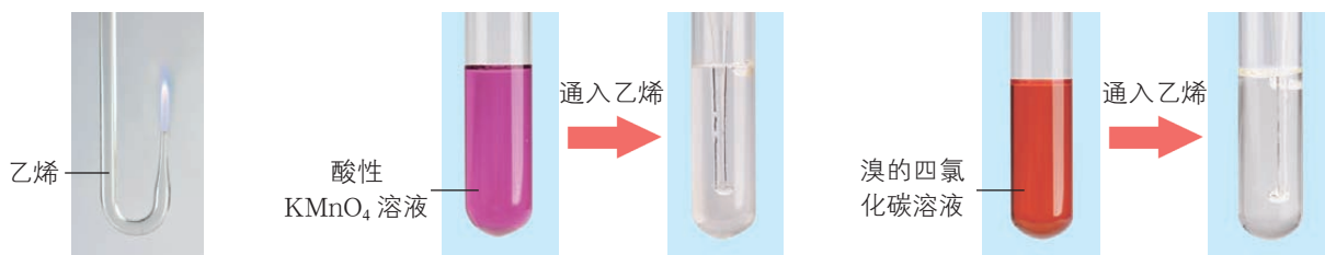
图3-2-8 探究乙烯化学性质的实验
