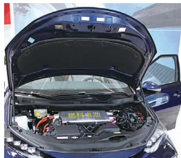
图2-2-14 用于驱动汽车的燃料电池
