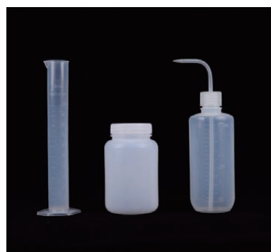
图3-2-13 用聚乙烯塑料制成的化学实验用品
