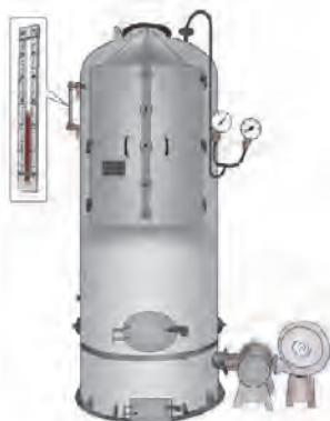
锅炉的水位计
