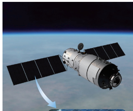
“天宫一号”上的太阳能电池板的基板是由玻璃纤维制成的。
