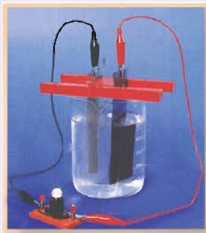
图9-11 化学能转化为电能的实验装置
