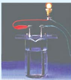
图7-6 酸碱溶液的导电性实验
