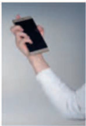
图研-4 用手机中的传感器测量手腕的向心加速度
