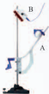
图 5.3-5 用传感器研究平抛运动的装置
