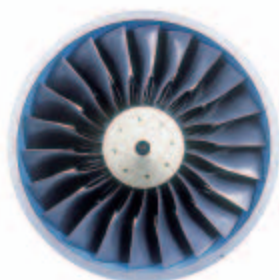
图3-21 喷气式飞机的发动机叶片是由镍、铁、碳和钴组成的镍钴合金制造的，能承受1100℃的高温
