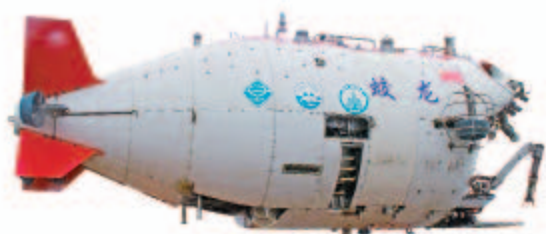
图3-20 我国“蛟龙”号载人潜水器最关键的部件——载人活动的耐压球壳是用钛合金制造的
