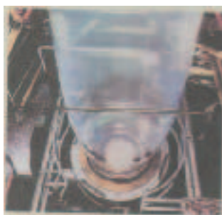
图 8-28 吹塑法生产聚乙烯薄膜
