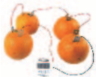
图 6-27 由橙子制成的简易电池
