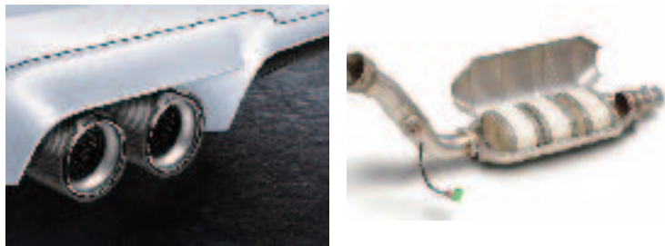
图 7-15 处理汽车尾气的催化转化器
