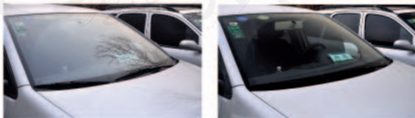
图 4.6-6 相机的偏振滤光片能减弱玻璃表面反射光的影响（右图）
