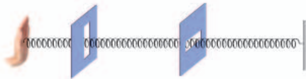
图 4.6-2 纵波可以穿过不同方向的狭缝
