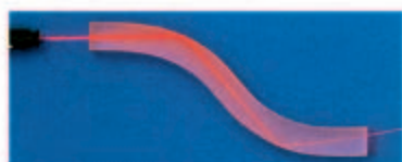
图 4.2-6 弯曲的有机玻璃棒能导光
