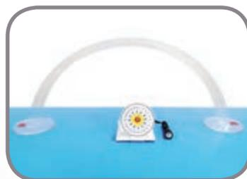
日晷由晷针和晷盘组成，在晷盘的正反两面各有12个大格，每个大格代表2小时（古代的一个时辰）。日晷摆放时坐南朝北（南高北低）。当太阳光照射到日晷上时，晷针的影子投向晷面。太阳由东向西移动时，晷针在晷面上的影子会慢慢地由西向东移动。这样，根据晷针影子的位置变化就可以指示时间。
