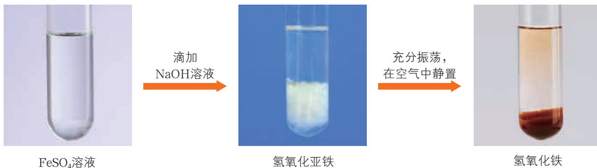
图 3-1-8 \text{FeSO}_4 溶液与 \text{NaOH} 溶液反应产生的氢氧化亚铁被空气中的氧气氧化为氢氧化铁
