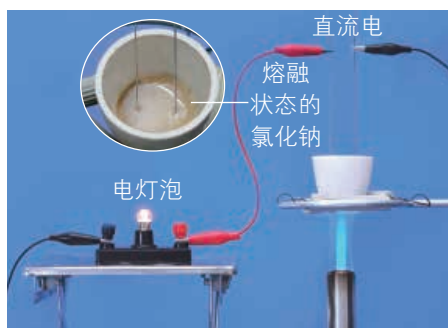
熔融状态的氯化钠能够导电
