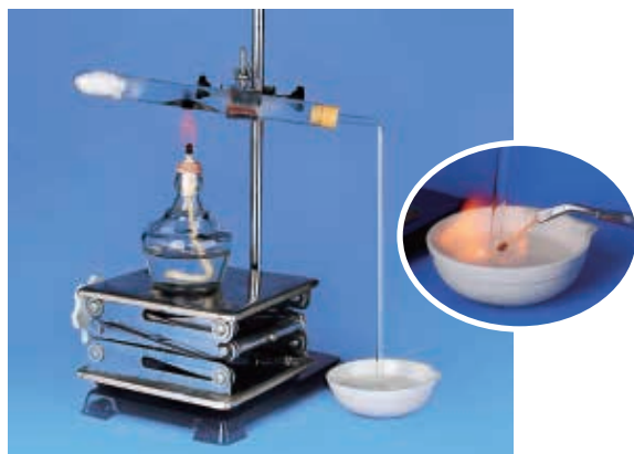
图 3-1-6 铁单质与水蒸气的反应
