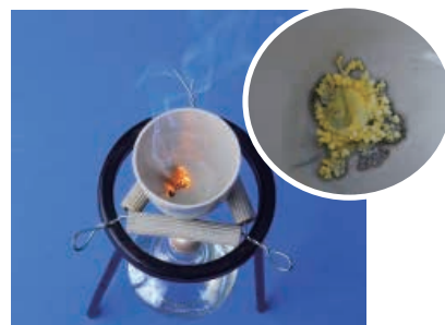
图 1-2-5 在空气中加热金属钠所发生的变化
