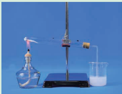
图 1-4-2 碳酸氢钠受热分解实验
