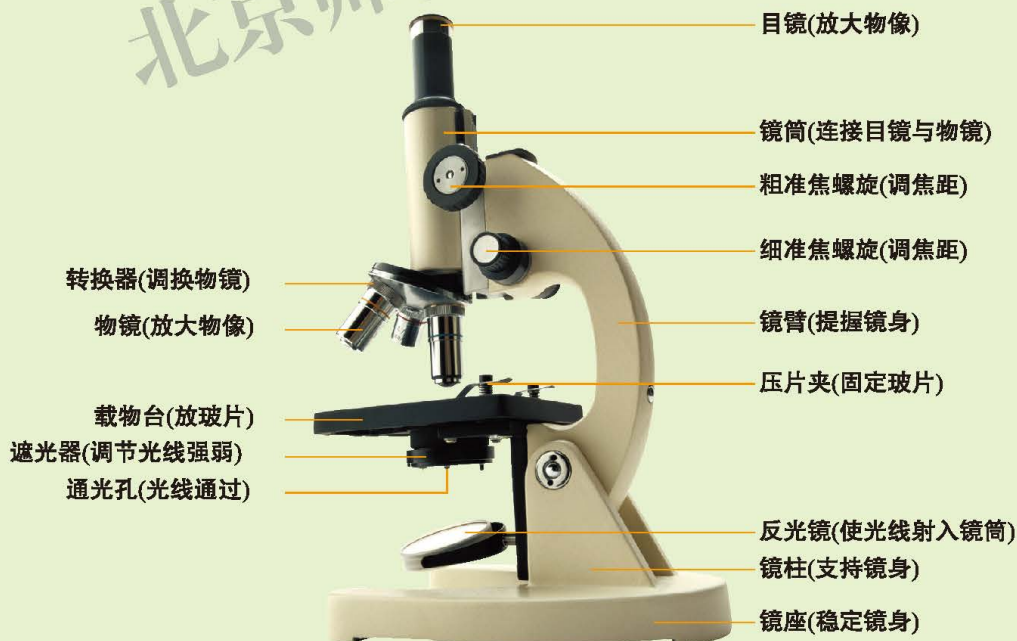
图3-2 普通光学显微镜结构图
