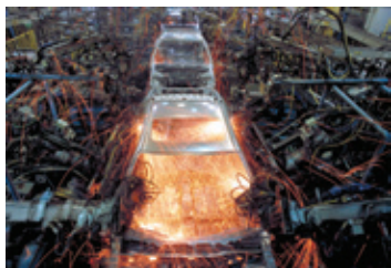
图4-7-4 这是汽车生产线上的机器人在对汽车车身进行激光焊接
