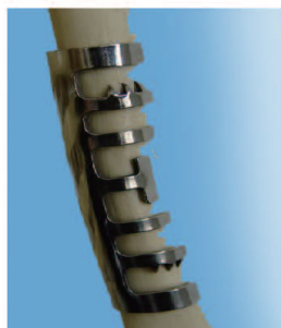
记忆合金制成的管状骨内固定器
