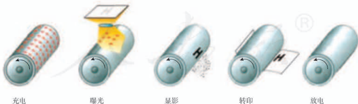
图 9.4-9 静电复印的工作流程
