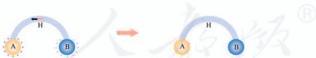
图 11.1-1 自由电子的定向运动使两个带电体成为等势体
