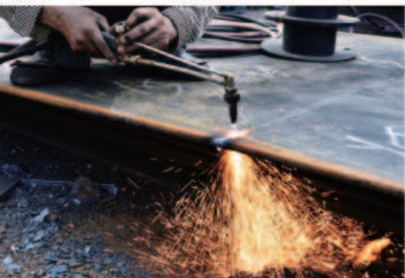
图1-1 乙炔与氧气反应放出的热量用于切割金属
