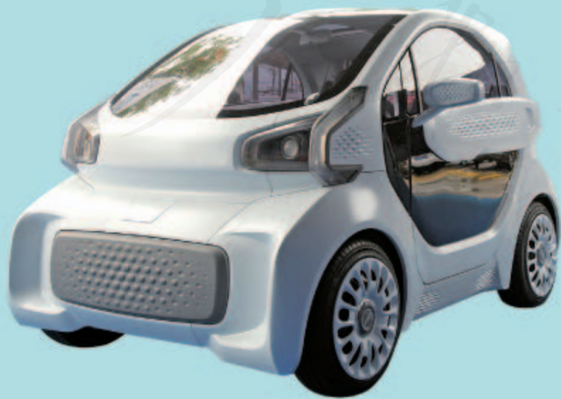
这款三维打印电动汽车的车重仅为0.5 t，续航里程为150 km
