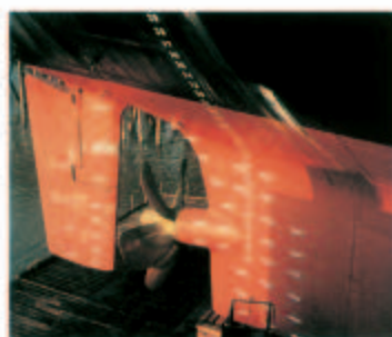
图4-25 牺牲船体上镶嵌的锌块，避免船体遭受腐蚀
