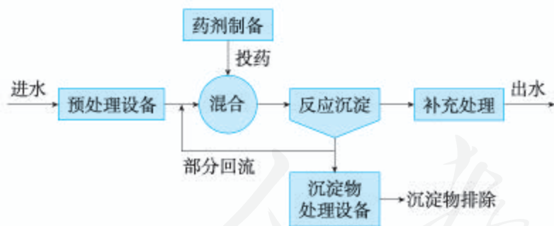
图3-14 化学沉淀法废水处理工艺流程示意图
