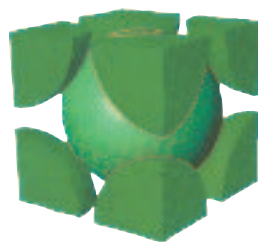
图 3-11 体心立方晶胞切面示意图
