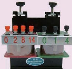
▲ 图3-3-4 可拆变压器
