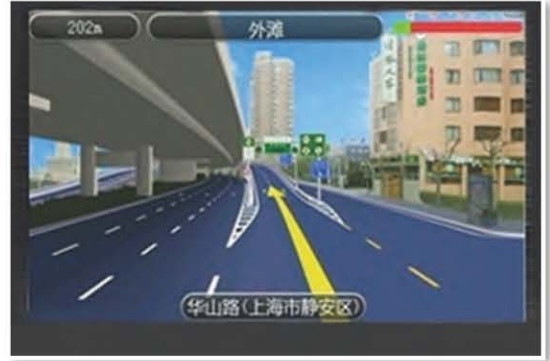
车载GPS导航系统 该系统把GPS的功能与电子地图相结合，可随时准确地显示车辆当前的位置、行车路线和方向。它实现了野外路勘、出游旅行的数字化智能导航。
