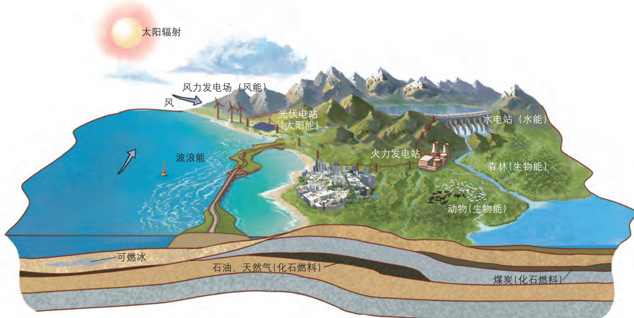
图 1-6 太阳能及其转换示意图
