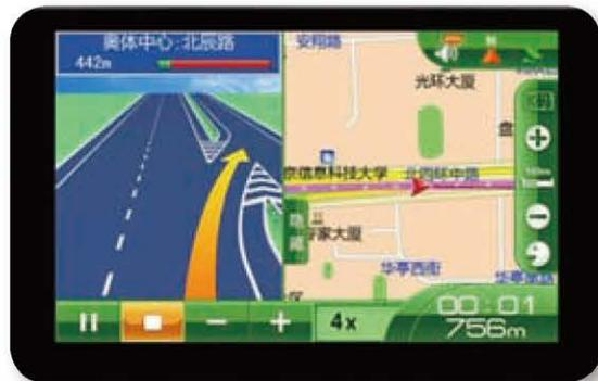
车载卫星导航系统 该系统把卫星导航的功能与电子地图相结合，可随时准确地显示车辆当前的位置、行车路线和方向，它实现了野外踏勘、出游旅行的数字化智能导航。
