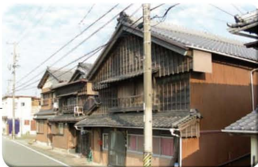
日本传统建筑 由于日本是地震多发国，所以传统的房屋多采用材料较轻的木质结构。
