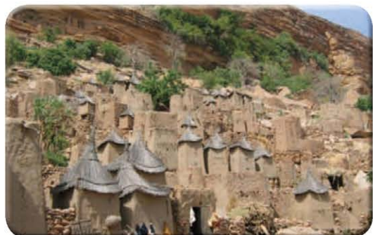
多贡人的村落 非洲马里的多贡人，在恶劣的自然条件下生活，用泥黏合石块砌成墙，用野草做屋顶。房子多建在陡坡上，以防外侵。
