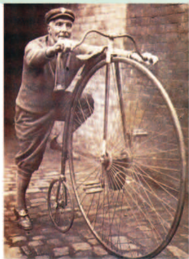
1870年英国制造商詹姆士·斯塔利制造的前轮大、后轮小的自行车。
