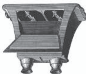
◇ 1849年大卫·布儒斯特 (David Brewster) 以凸透镜取代立体镜中的镜子，发明了改良型的立体镜。
