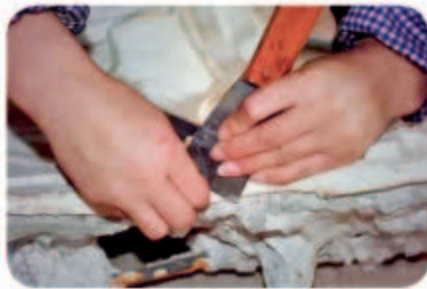
2. 模具翻制。共有两种方法：一种是石膏翻制，主要用于制作造型不太复杂的作品；另一种是硅胶翻制，主要用于制作造型复杂的作品。
