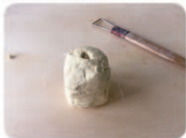
5. 用雕塑刀在雕塑泥顶端修出注浆口。
