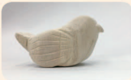
9. 把各个棱角锉圆后，再用由粗到细的砂纸打磨，直至表面光滑。
