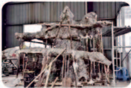
2. 模具翻制。共有两种方法：一种是石膏翻制，主要用于制作造型不太复杂的作品；另一种是硅胶翻制，主要用于制作造型复杂的作品。
