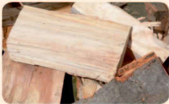
1. 选材。尽量选择没有裂纹、木纹精致、木质紧密的干燥木材。
