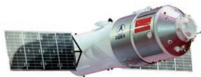
“天宫”一号全长 10.4 米，最大直径 3.35 米，重 8.5 吨，设计在轨寿命为 2 年
