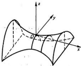
用平面  $x=t$  截此曲面, 所得截痕  $l$  为平面  $x=t$  上的抛物线  $-\frac{y^2}{b^2} = z - \frac{t^2}{a^2}$ , 此抛物线开口朝下, 其顶点坐标为  $x=t, y=0, z=\frac{t^2}{a^2}$ 。当  $t$  变化时,  $l$  的形状不变, 位置只作平移, 而  $l$  的顶点轨迹  $L$  为平面  $y=0$  上的抛物线  $z=\frac{x^2}{a^2}$ 。因此, 以  $l$  为母线,  $L$  为准线, 母线  $l$  的顶点在准线  $L$  上滑动, 且母线作平行移动, 这样得到双曲抛物面的方程:  $\frac{x^2}{a^2} - \frac{y^2}{b^2} = z$ 。
