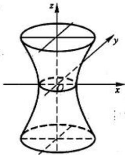
把  $xOz$  面上的双曲线  $\frac{x^2}{a^2} - \frac{z^2}{c^2} = 1$  绕  $z$  轴旋转, 得旋转单叶双曲面  $\frac{x^2+y^2}{a^2} - \frac{z^2}{c^2} = 1$ , 把此旋转曲面沿  $y$  轴方向伸缩  $\frac{b}{a}$  倍, 即得单叶双曲面方程:  $\frac{x^2}{a^2} + \frac{y^2}{b^2} - \frac{z^2}{c^2} = 1$ 。
