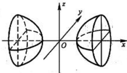
把  $xOz$  面上的双曲线  $\frac{x^2}{a^2} - \frac{z^2}{c^2} = 1$  绕  $x$  轴旋转, 得旋转双叶双曲面  $\frac{x^2}{a^2} - \frac{y^2 + z^2}{c^2} = 1$ , 把此旋转曲面沿  $y$  轴方向伸缩  $\frac{b}{c}$  倍, 即得双叶双曲面方程:  $\frac{x^2}{a^2} - \frac{y^2}{b^2} - \frac{z^2}{c^2} = 1$
