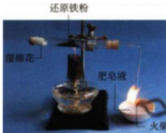
图 3-8 铁粉与水蒸气反应
