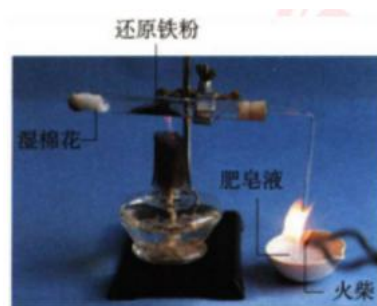
图 3-8 铁粉与水蒸气反应
