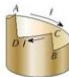
图 2.7-2 闭合电路的电势。A、B 两个位置与上图中的 A、B 相对应。D、C 则分别代表电池的溶液中与 A、B 两电极靠近的位置。
