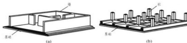
图 4-1-12 筏形基础 (a) 板式; (b) 梁板式
