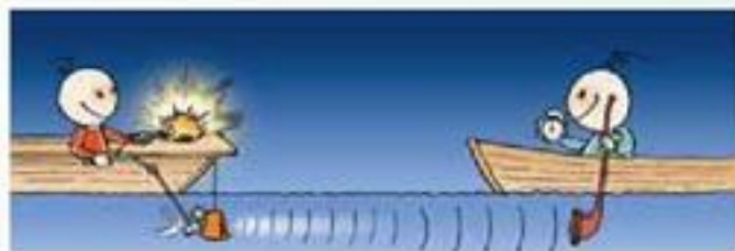
图 12.3-4 第一次测定水中声速的示意图
