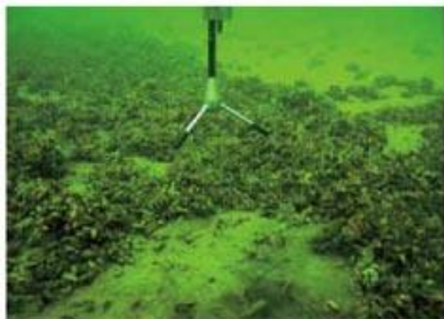
多普勒测速仪测量水在河底的流速，为养殖场寻找适合蚌类生长的场所。
