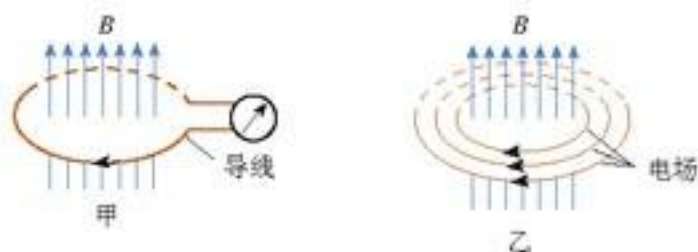
图 14.1-1 变化的磁场产生电场
