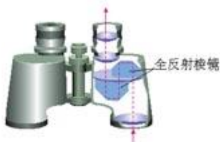
图13.7-5 双筒望远镜中的全反射棱镜
