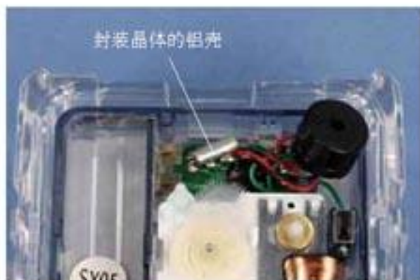
图14.2-4 石英电子钟的振荡器里用的晶体
