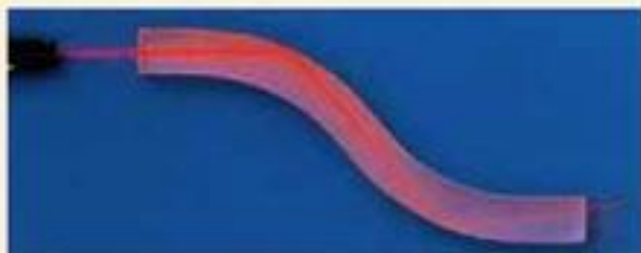
图13.7-6 弯曲的丙烯酸树脂棒能导光
