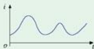
图14.4-8 音频电流的大小模拟声压的变化，是模拟信号。
