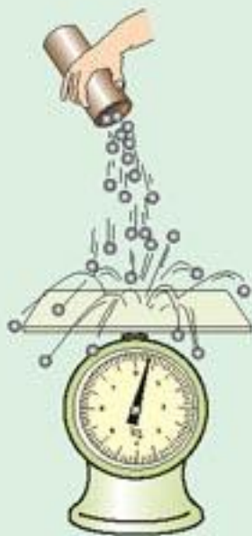
图8.4-4 模拟气体压强产生机理的实验
