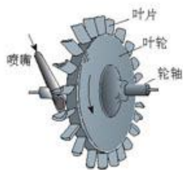
甲 汽轮机的工作原理
