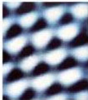
图7.1-3 用扫描隧道显微镜拍摄的石墨表面原子照片
