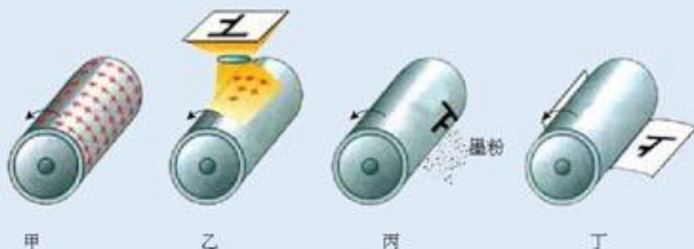
图1.2-5 静电复印的工作流程
