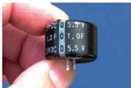
图1.8-4 现在已经能够制成电容超过1 F的电容器
