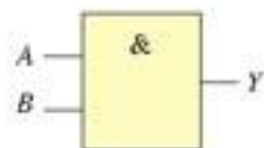
图 2.10-4 “与”门的符号。矩形中的“&”在英语中代表“and”，具有“与”的意思。它象征着：只有 A 与 B 两个输入端都是 1 时，输出端才是 1。
