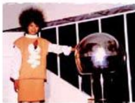
图1.3-9 散开的头发大致显示电场线的分布
