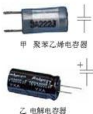
图1.8-6 固定电容器及其符号
