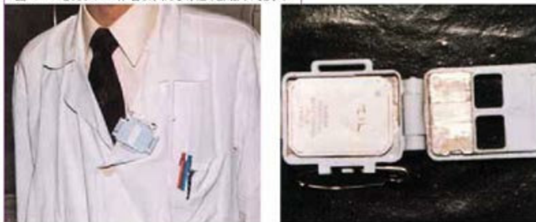
图 5.4-1 核技术工作者佩带封有感光底片的胸章
