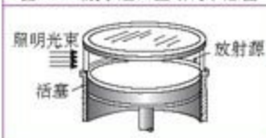
图 5.4-2 威尔逊云室结构示意图
