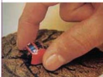
丙 小型机器人能够进入各种管道进行检查
