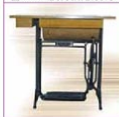
图 3.4-3 缝纫机踏板机构
