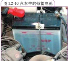
图 12-10 汽车中的铅蓄电池
