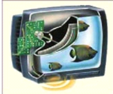
图 5.3-2 彩色电视机显像管示意图
