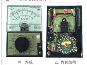
图 1.3-1 多用电表的结构
