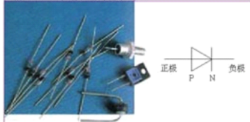
图 1.4-16 二极管和它的符号
