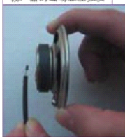
图2.3-11 检测一只收音机扬声器的磁场感应强度
