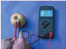
图 12-3 测量水果电池的电动势
