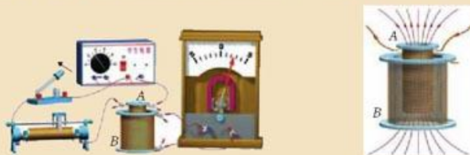
图3.1-5 由开关控制线圈中的磁通量变化, 也产生电磁感应现象吗?
