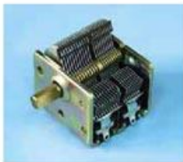
图1.4-8 可变电容器。两组铝片之间是互相绝缘的,动片旋入得越多,正对面积越大,电容也就越大。
