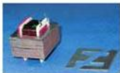
图3.6-6 硅钢片是一种很好的软磁性材料
