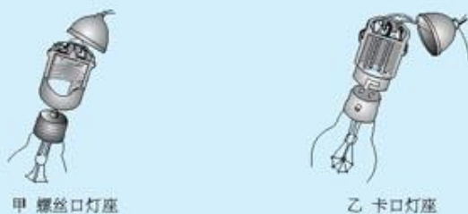
图1.6-3 两种灯口的结构
