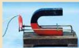
图2.3-1 磁场对通电导线有力的作用
