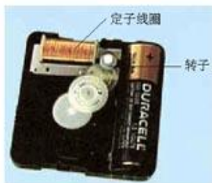
图2.3-7 时钟上的直流电动机
