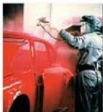
图1.3-11 当油漆从喷枪中喷出时,喷嘴使油漆微粒带正电,它们相互排斥,扩散开来形成一大团漆云,被吸附在带负电的物体表面。这种静电喷漆的方法省漆而均匀。
