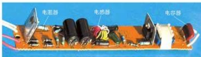
图3.6-4 日光灯电子镇流器，其中有电阻器、电容器、电感器。
