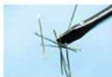
图2.5-1 螺丝刀与磁铁接触后磁化
