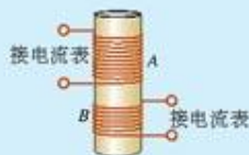
图3.2-3 哪个线圈中的感应电动势大些?
