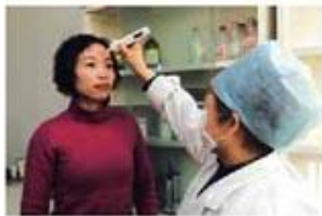
图4.2-5 人体也发射红外线。体温越高,发射的红外线越强。根据这个原理,红外体温计不与身体接触也可以测体温。
