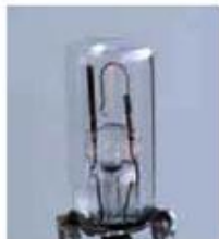
图4.4-4 日光灯启动器里有一个双金属温度传感器
