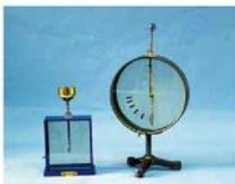
图1.1-2 左侧装置叫做验电器，金属杆下端的两片金属箔能因带同种电荷而张开，显示带了电。右侧是一种特殊的验电器，叫做静电计，指针偏转的角度可以表示带电的多少。
