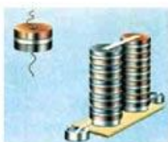
图1.5-2 伏打电堆：在锌片和铜片之间夹上浸透了盐水或碱水的厚纸、布片或皮革，再把几十个这样的单元叠置起来。
