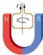
图2.3-5 通电线圈在磁场中受到安培力会扭转,电动机就是根据这个原理设计的。
