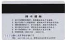
图2.5-5 磁卡。背面的黑条是用做磁记录的磁条。
