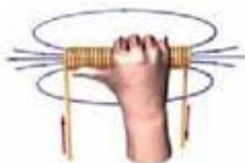
图2.2-4 通电螺线管的磁场
