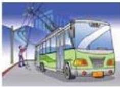
图3.6-1 自感使电车拾电器产生电火花
