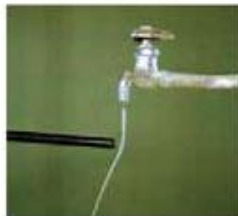
带电橡胶棒与水流没有接触, 就可以发生静电力的作用。
