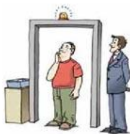
图3.6-8 用于安全检查的“门”。导线沿着“门框”绕成线圈，金属物品通过“门”时产生涡流，涡流的磁场又反过来影响线圈中的电流，引发报警。
