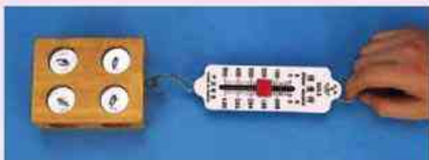
图3.3-2 测力计指针下面的小纸团可以“记住”拉力曾经达到的最大值。
