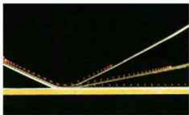
图 4.1-1 现代人所做伽利略斜面实验的频闪照片(组合图)
