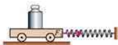
甲 被拉长的弹簧使小车向右运动
