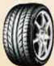
图3.3-4 轮胎表面都有花纹状的沟槽。雨天，沟槽能把轮胎与地面间的水排出，保持两者的良好接触以产生足够的摩擦力。沟槽的深度小于 2 mm 时轮胎就不应再使用了。
