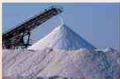
图3.3-3 传送带靠静摩擦力把货物送到高处
