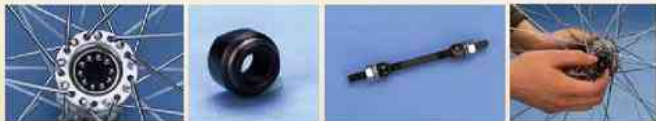
图3.3-7 安装自行车的滚动轴承
