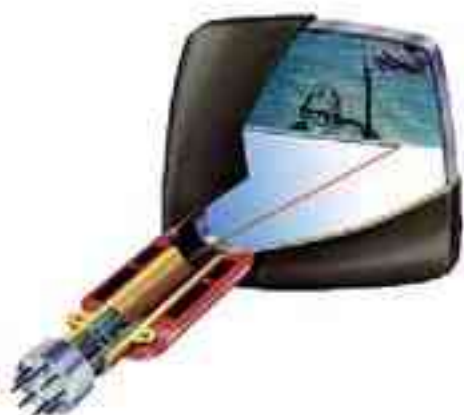
图 0-2 电视机显像管的剖面图
