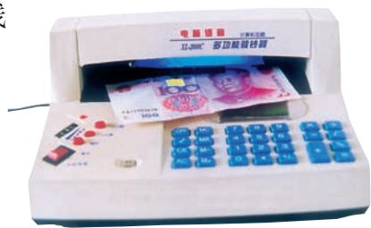
图4.5-7 紫外线使钞票上的荧光物质发光
