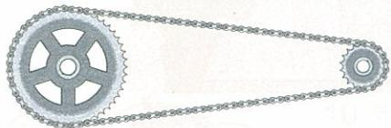
前齿轮转动一圈的长度就是链条走过的长度，后齿轮也要转动同样的长度。所以……
